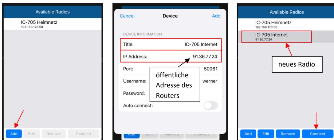
**Bild 14: Erstellung eines zusätzlichen Radios "IC-705 Internet"**
