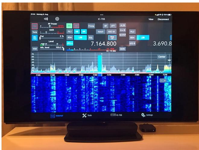
**Bild 21: IC-705 auf einem Fernsehgerät (AppleTV)**
