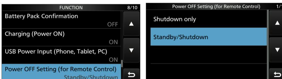
**Bild 22: Unter Set -> Functions -> Power OFF Setting -> Standby/Shutdown wählen**
