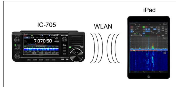
Bild 2: SDR-Control im "Access Point Modus"
