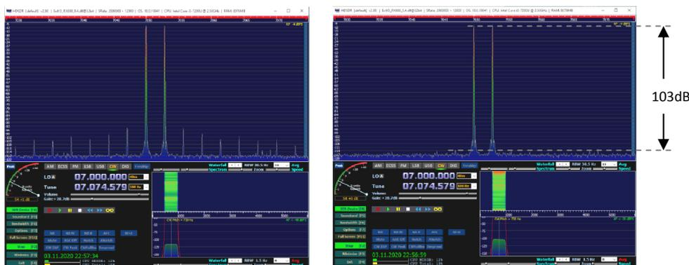
**Bild 12: 2-Ton Signal ohne (links) und mit Dithering (IP+) (rechts)**
