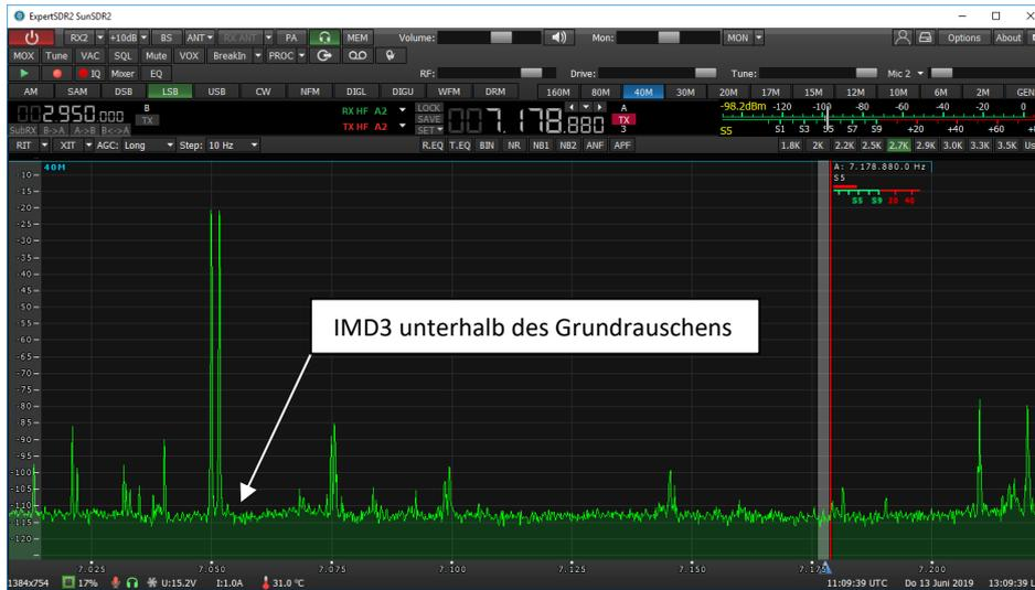
**Bild 12:** Bei  $P_e=2x-20\text{dBm}$  verschwinden die IM3-Produkte im Grundrauschen des Empfängers
