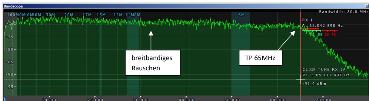
**Bild 17: Spektrum am Bandscope mit Wide RX-Filter on**
