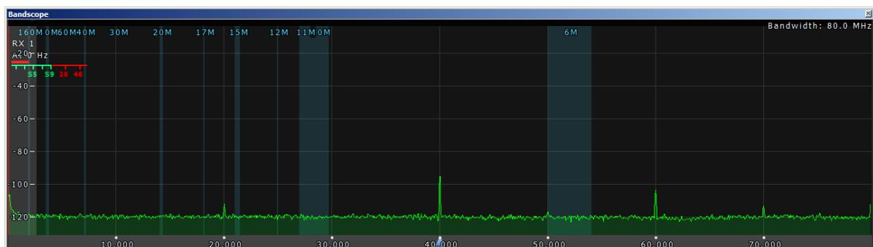
**Bild 19: Receiver Spurious Signals von 0-80MHz**
