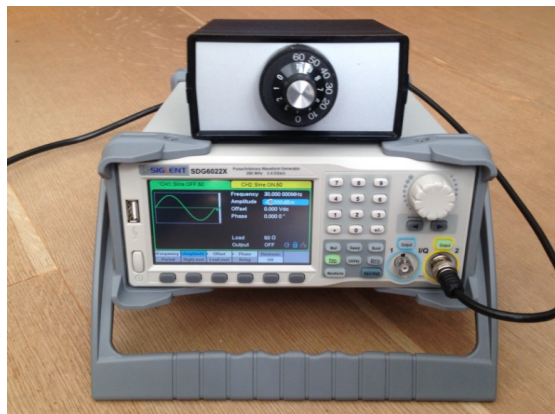
Bild 10: SDG6022X mit einem zusätzlichen, stellbaren Dämpfungsglied 0-70dB
