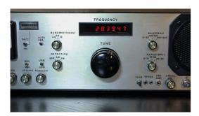
Bild 14: Analoger KW-Receiver, Frequenzbereich 0,1-30MHz, ohne Preselector, IP<sub>3</sub>= +26dBm
