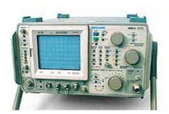
Bild 11: TEK 492P Spektrum Analysator
