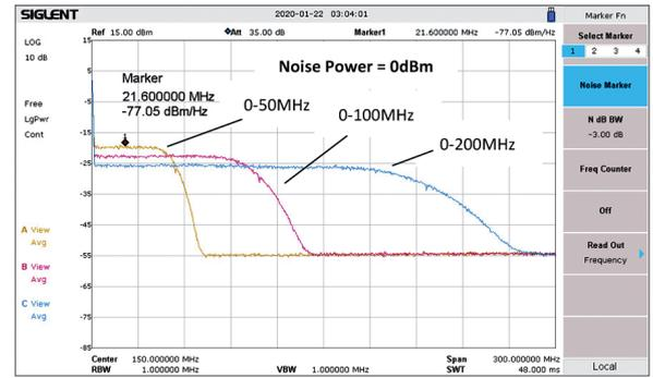
**Bild 2: Rauschsignale des SDG6022X**
