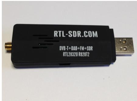
Bild 1: "RTL-SDR.COM", DVBT-Stick RTL2832U R820T2 TCXO, 24 – 1766MHz
