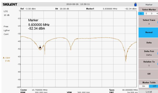
**Bild 5: Falsch positioniertes Mantelwellenfilter verschiebt die Resonanzen**
