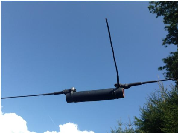
**Bild 6: Stück Draht (Stub) am Ausgang der 1. Verlängerungsspule**
