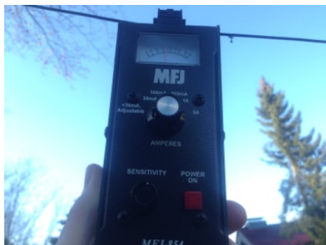
Bild 8: Messung des Antennenstroms im Strommaximum (Spannungsknoten) der Drahtantenne mit einem HF-Zangenamperemeter "MJF-854 RF-Current Meter"
