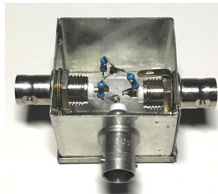
Bild 1: Splitter/Combiner mit Widerständen
