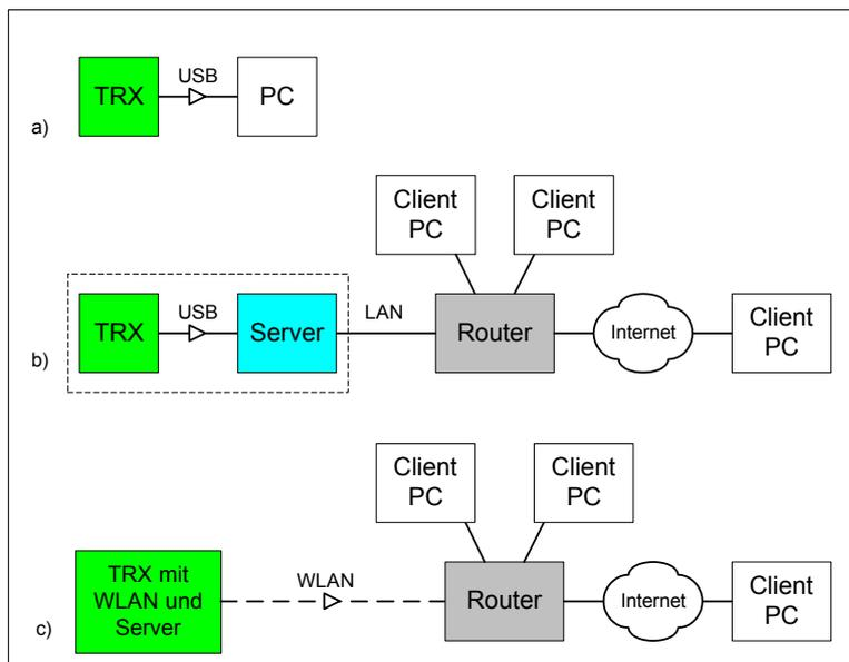
**Bild 1: Verschiedene Möglichkeiten zur Fernsteuerung eines SDR-Transceivers**
