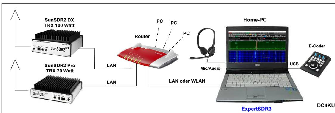
**Bild 2: Zwei Transceiver von Expert Electronics mit Verbindung ins lokale Heimnetzwerk**
