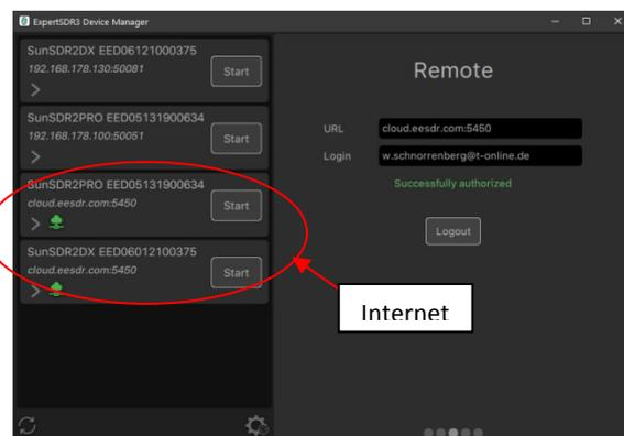
**Bild 12: ExpertSDR3 öffnen und Transceiver über Heimnetz (links) oder Internet (rechts) steuern**
