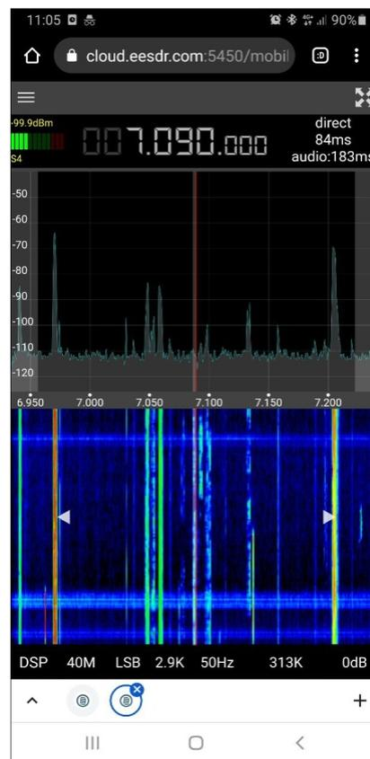
**Bild 16:** Fernsteuerung am Web-Browser eines Smartphone (Samsung, Galaxy)
