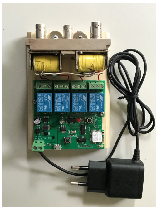
Bild 6: Komplett montierter Antennen-Umschalter (links) und aktiv im RadioShack (rechts)
