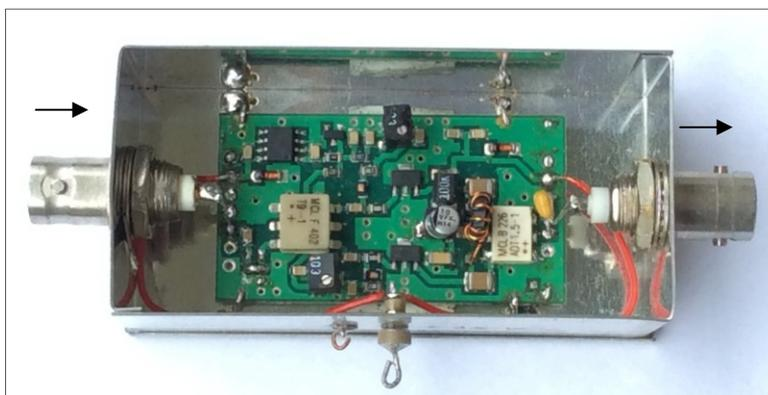
**Bild 9: 1-W-Linearverstärker als fertiges Modul**
