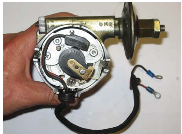
Verteiler mit eingebauter Elektronik
