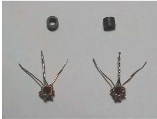
Bild 29: Aufbau des modifizierten 3-dB-Power-Splitters (links) und Ringkerne (rechts)
