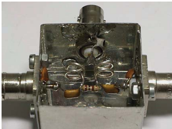
Bild 14: Versuchsaufbau eines 433 MHz-Wilkinson-Teilers mit L-C-Kreisen im Weißblechgehäuse, Abmessungen 37x37x30mm
