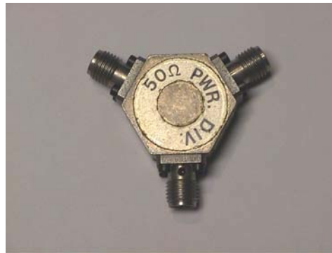
Bild 3: Beispiel eines resistiven Power-Splitters, 0-18 GHz
