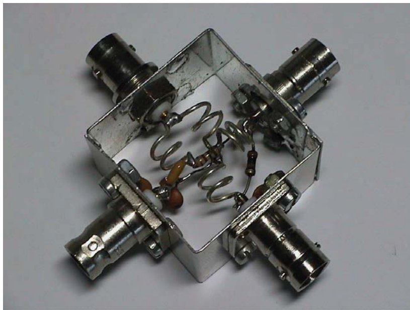
Bild 18: Versuchsaufbau eines Wilkinson-Teilers „1 auf 3“
