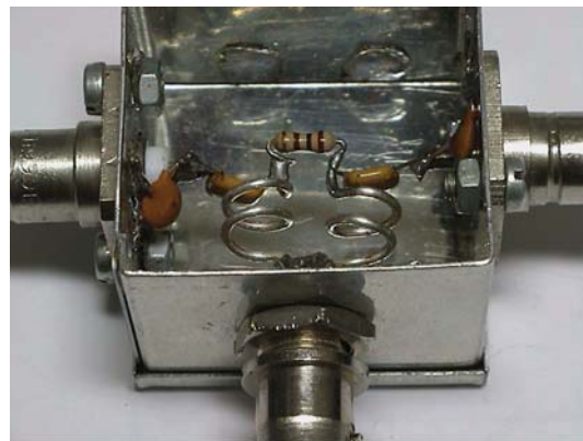
Bild 14: Versuchsaufbau eines 433 MHz-Wilkinson-Teilers mit L-C-Kreisen im Weißblechgehäuse, Abmessungen 37x37x30mm
